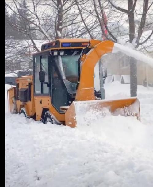
La direction positive et précise de la souffleuse à neige dans les espaces confinés et autour des obstacles est due à sa direction articulée. La possibilité de déplacer la souffleuse sur le côté en tournant simplement le volant permet à l'opérateur d'approcher toute obstruction de façon sécuritaire.
